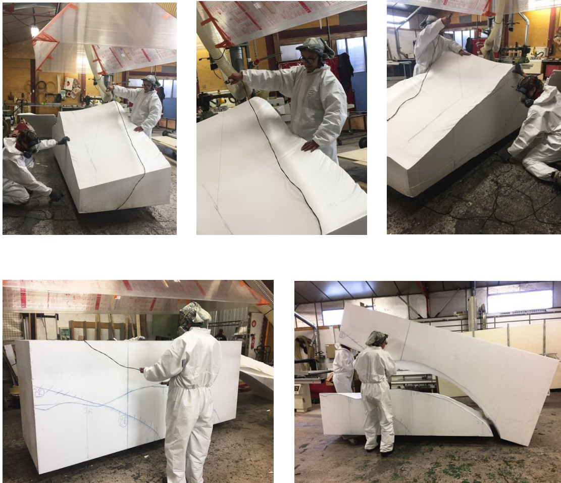
Photos 63 à 67 : Travail sur calque film plastique, traçage de ligne de coupe avec la roue à dents et découpe des pièces de polystyrène au fil chaud sous la hotte aspirante
