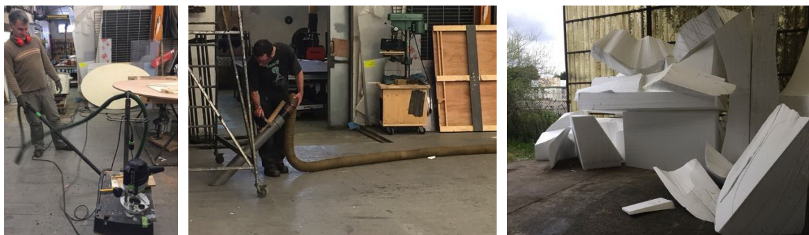
Photos 77, 78, 79 : Aspiration et stockage des résidus de coupe en attente d'être acheminé vers un site de traitement
