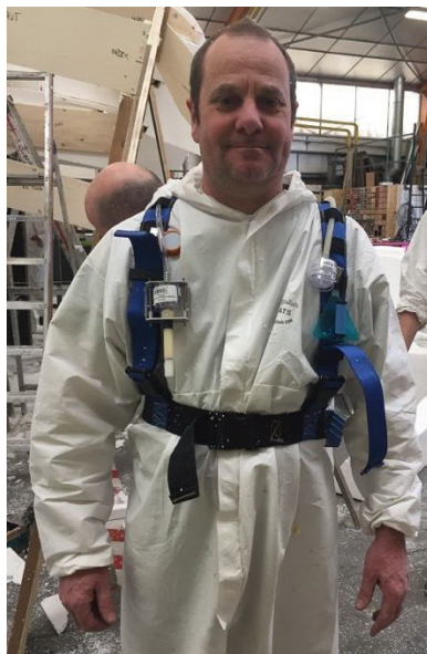
Photos 117, 118 : Position du capteur sur un harnais spécifique
