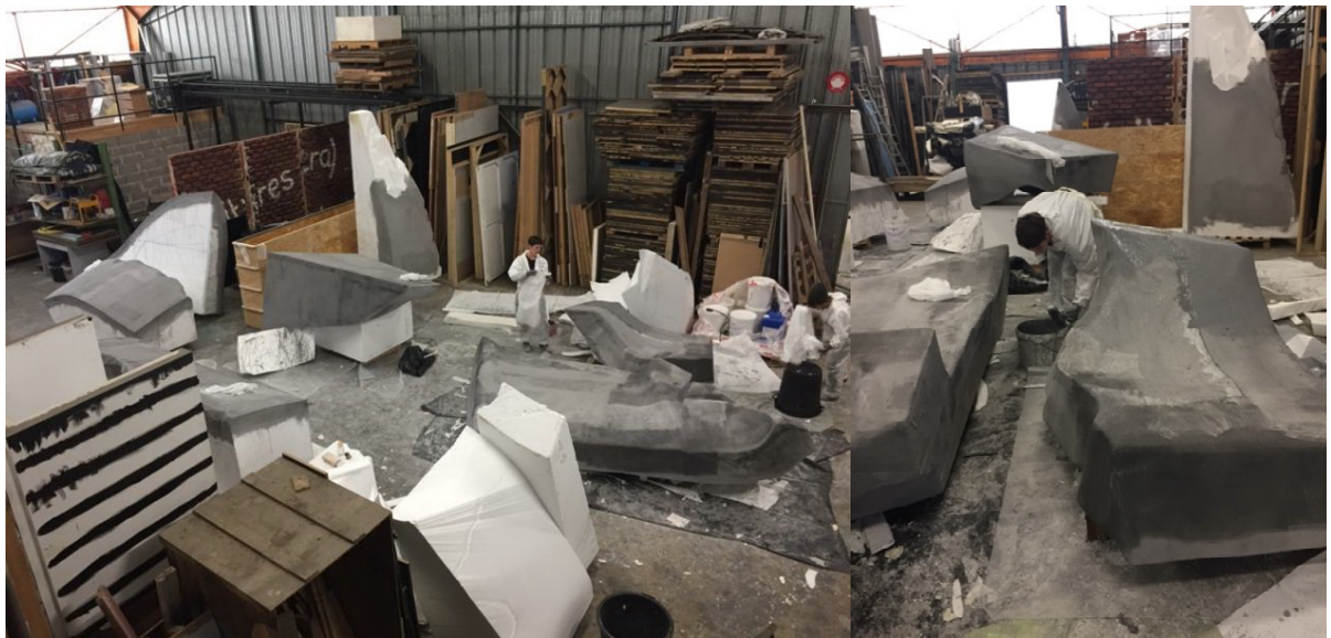
Photos 97, 98 : Recouvrement des pièces du décor par les tissus spéciaux enduits
